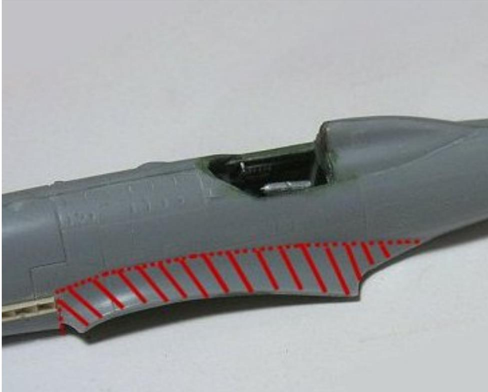
Un raccord karman (du nom du physicien d'origine hongroise [Théodor von Karman](#) ), est une pièce d'un avion, destinée à faciliter l'écoulement de l'air au niveau du raccord entre l'aile et le fuselage. (partie hachurée sur l'illustration ci-contre)
